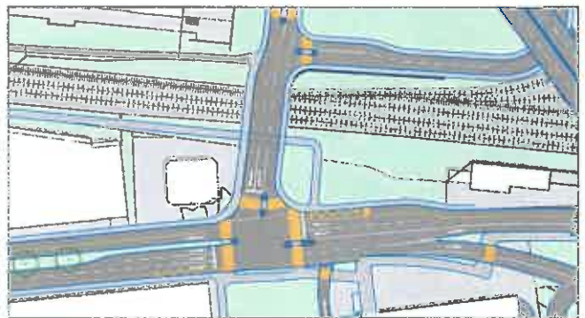
Abb. 12: Anzustrebender Zustand 2035: Ausbau der Seedamm-Brücke und 3. Fahrstreifen in Richtung Osten (bedingt Abriss Garage und Restaurant). Die Bushaltestellen liegen optimal. (Quelle: SNZ: Freienbach, Abklärungen Pfäffikon Ost für Vereinbarung mit ASTRA, Entwurf, 6.4.17, S. 7.)
